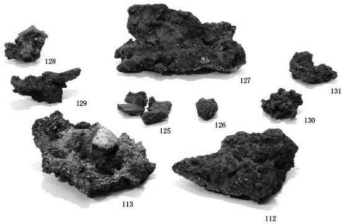
112・113 (炉壁)・125 (工具付鉄滓)・126 (焼結砂鉄塊)・127～131 (その他炉内滓)
