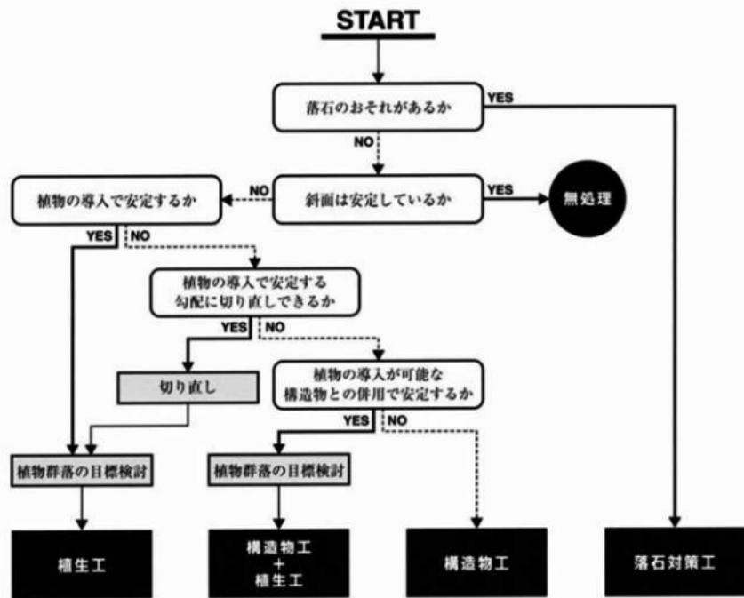
図-2 斜面保護工選定の考え方及び手順
