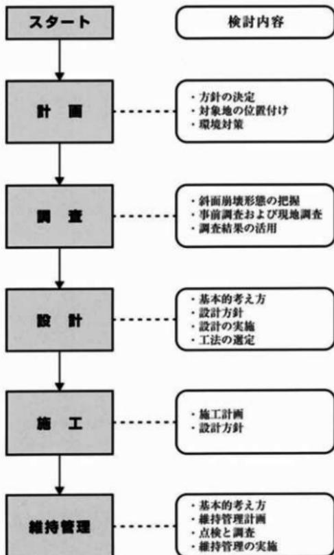
図-1 斜面保護工検討フロー
