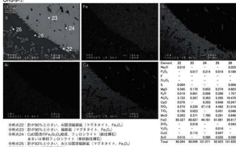
写真17 炉壁溶融津のEPMA調査
