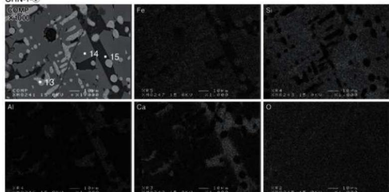
写真15 鉄塊系遺物のEPMA調査
