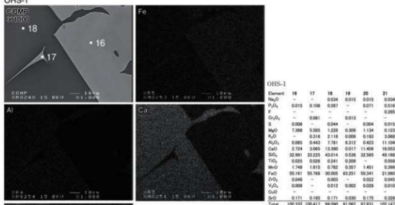
分析点16：MgOとCaO固溶ファヤライト ( $2FeO \cdot SiO_2$ )分析点17：MgOとCaO固溶ファヤライト ( $2FeO \cdot SiO_2$ )
