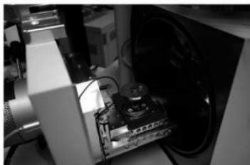
電子顕微鏡の試料室部分
