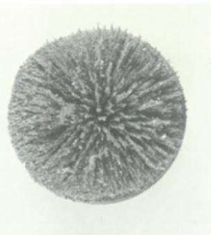
図版4 磁石による砂鉄の吸引状況
