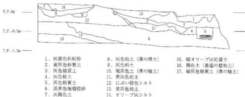
第24図 C地区基礎断ち割り土層断面実測図 (南北方向)
