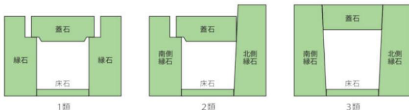
第9図 中蓋付溝の構造模式図
