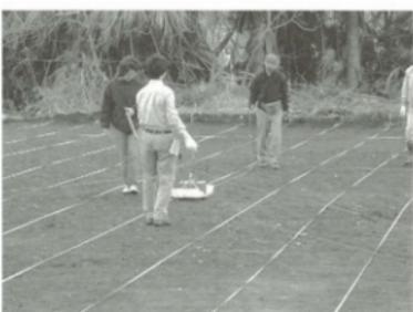
写真2 地中レーダ探査風景
