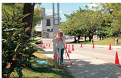
光波測量機による測量状況
