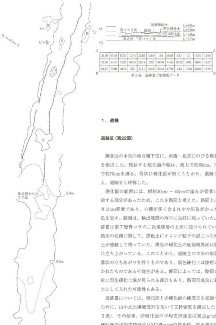
第22図 道跡III平面図・断面図 (S=1/50)
