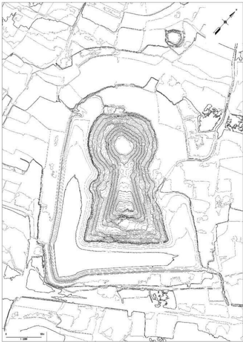
両宮山古墳測量図（航空レーザ計測による）
