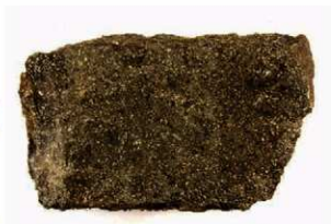
2. 試料2 石積6(トレンチ2a) 斜方輝石単斜輝石安山岩
