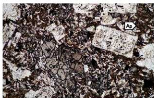
3. 試料3 石積7東部 単斜輝石斜方輝石安山岩
