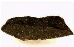
2. 試料2 石積6(トレンチ2a) 斜方輝石単斜輝石安山岩
