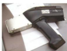
図1 ハンディ型蛍光X線分析装置
