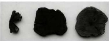
写真7 同 無処理・PEG 処理後・FD 処理後
