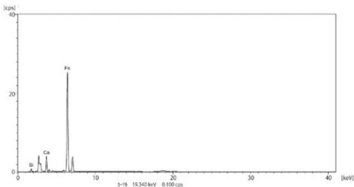
第123図 資料No. 3（赤色部）のED-XRF測定結果
