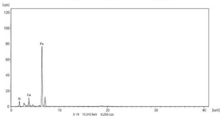
第124図 資料No. 3（黒色部）のED-XRF測定結果
