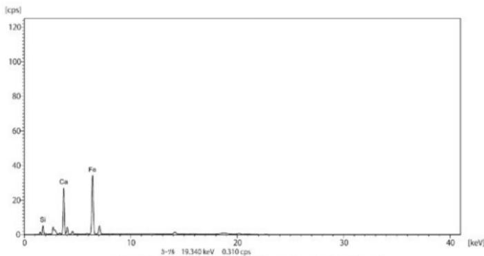
第122図 資料No. 2（茶色部）のED-XRF測定結果
