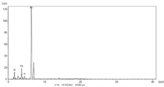
第120図 資料No. 2（赤色部）のED-XRF測定結果
