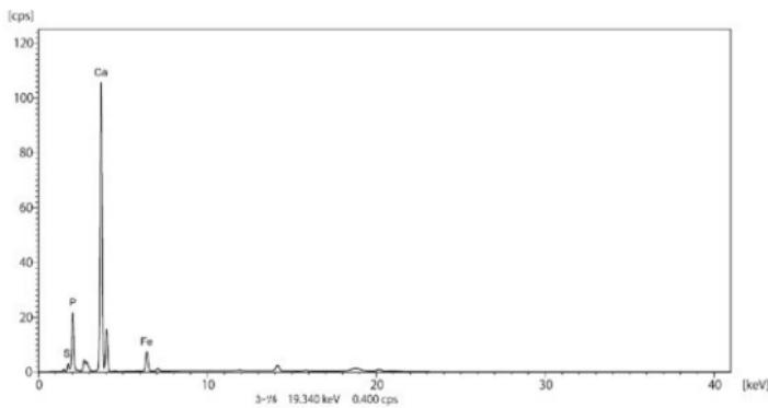
第121図 資料No. 2（白色部）のED-XRF測定結果
