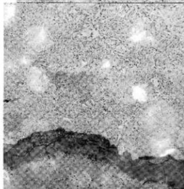
Photo.14 鉄鋳状未製品の顕微鏡組織
