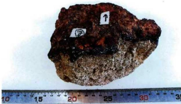
写真4 資料No.3 (2号炉地下構造底部より採取した炉壁) - A面
