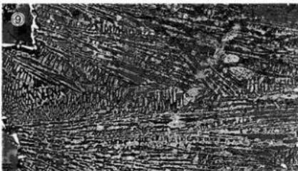
Photo.11 再結合滓の顕微鏡組織
