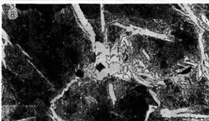
Photo. 4 鉄滓の顕微鏡組織
