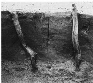
写真2 液状化現象により折れ曲がった杭
