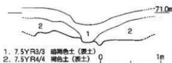
図49 SD02断面図(Sec.7)図(1:40)
