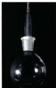
Fig.8 ピクノメータ法による管玉試料の密度測定
