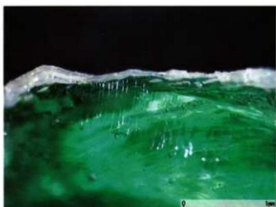
Fig.2 試料No.1の断面 表面は風化したガラス層に覆われている
