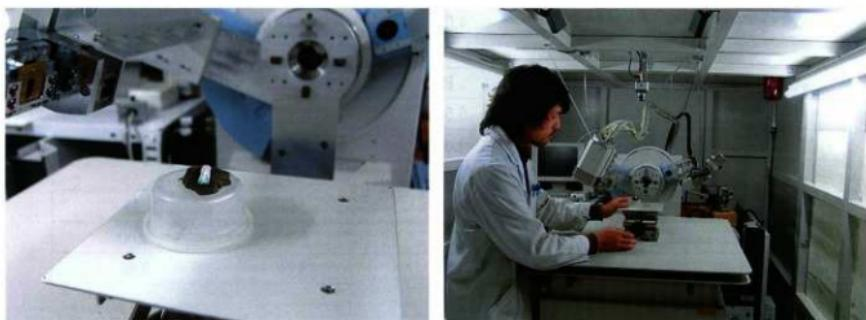
Fig.9 平行ビーム形非破壊 X 線回折分析装置 (試料の設置にあたっては、分析箇所をレーザで照準を定める方式によった。右図の左には X 線対陰極と右には検出器を備えた装置)
