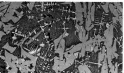
Photo. 3 鉄津の顕微鏡組織
