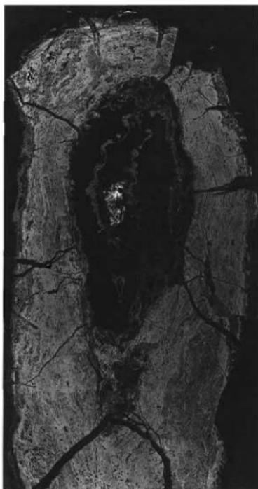
Photo.14 鉄製品（鍛造品）(MIY-11) のマクロ組織
