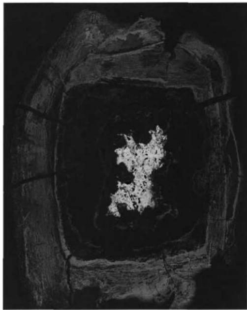
Photo.13 鉄釘（MIY-10）のマクロ組織（ $\times 10$ ）
