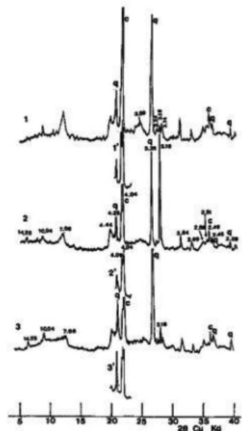
図-27 大井蒸跡周辺放置原料土のX線回折図
