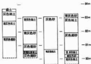
図61 湖岸堤志那北土層柱状図
