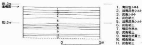
図13 湖岸堤赤野井南(その1)基本土層図
