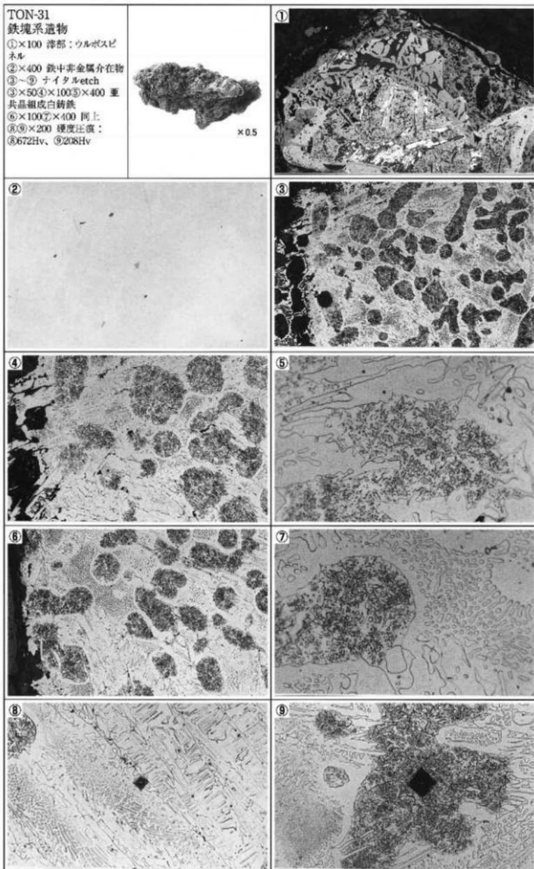
Photo.22 鉄塊系遺物の顕微鏡組織
