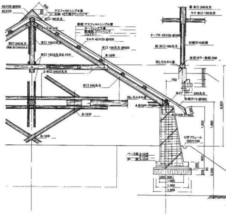
第118図 保護棟設計図（構造）
