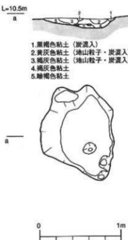
第122図 SK01遺構実測図(S=1/40)
