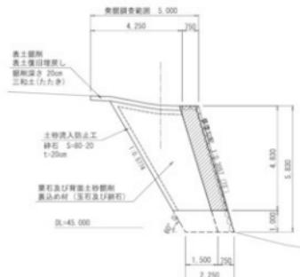
第2466図 清水門石垣A面復旧標準断面図
