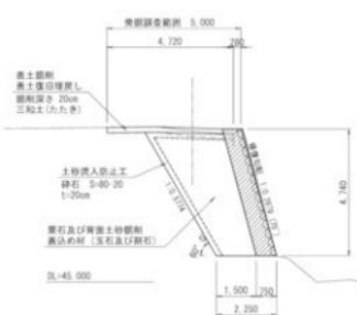
第2467図 清水門石垣B面復旧標準断面図
