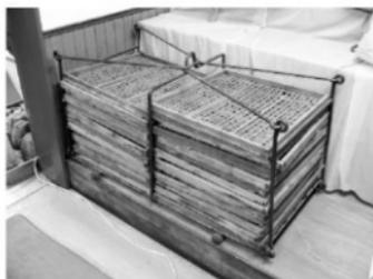
写真6 オンパと呼ばれる鉄製の吊り枠に収めた蒸籠
