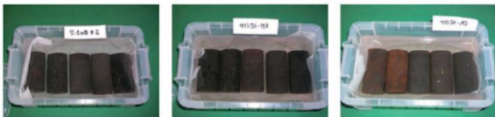
各石材の見かけ比重を測定後、強化剤は下記の3種類選択して1日間浸漬法にて含浸した。
