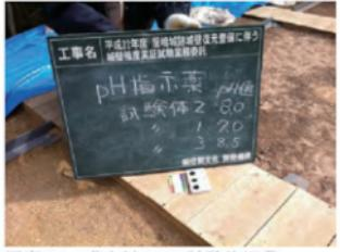
写真 69 盛土材のpH試験状況①
