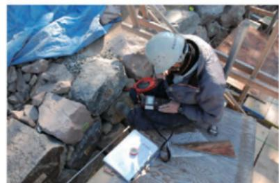
写真 234 ひずみ計計測状況②
