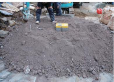
写真 138 最適含水比測定状況 (北から)
