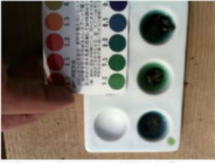
写真 70 盛土材のpH試験状況②
