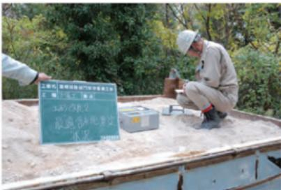
写真 130 最適含水比測定状況
