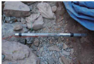
写真 231 ひずみ計設置状況①
