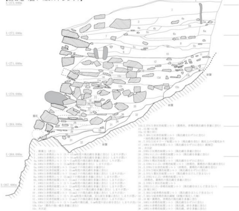
図62 城門南側城壁土層断面図 ( $S = 1/50$ )
