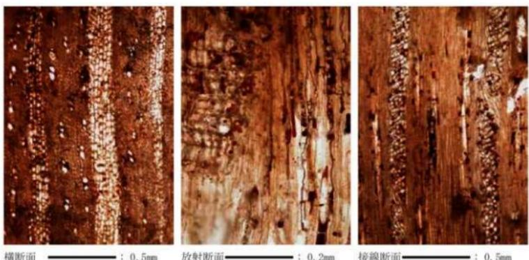
横断面 : 0.5mm 放射断面 : 0.2mm 接線断面 : 0.5mm
