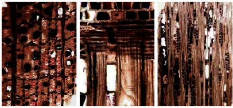
横断面 : 0.2mm 放射断面 : 0.1mm 接線断面 : 0.2mm
