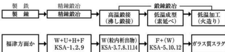
Fig. 1 鍛冶工程模式図
