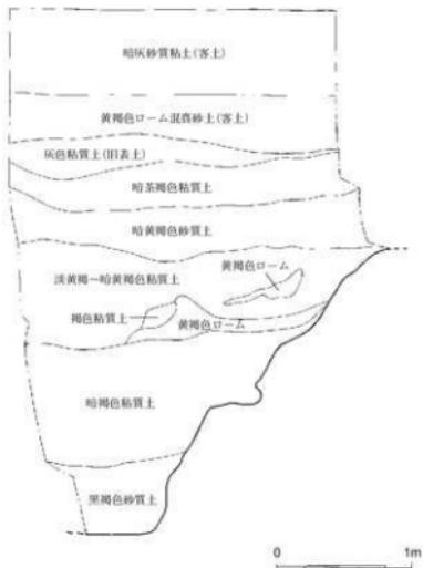
Fig.112 D区SD07溝跡土層断面実測図 (1/40)
