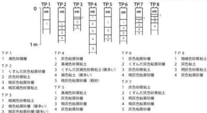
第 98 図 字石田トレンチ柱状図 S= 1/400
