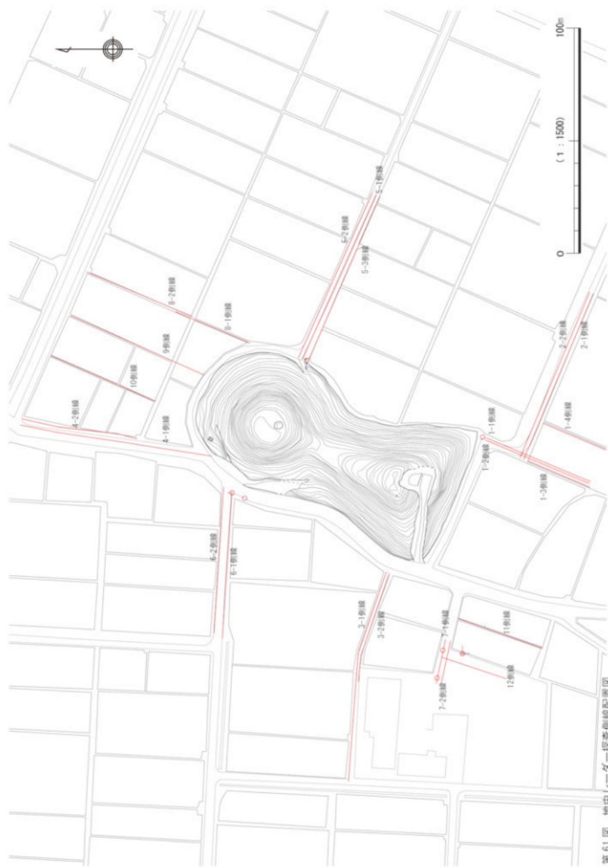
第61図 地中レーダー探査側線配置図
