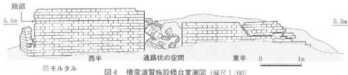
図4 橋梁演習施設橋台実測図（縮尺1/60）
