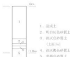
図11 土層柱状図（縮尺1/30）
