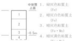
図12 土層柱状図（縮尺1/30）
