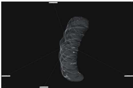
図 34 X線CTで得られた銀製指輪開口部における銀線構造の解析
