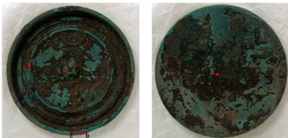
図1 分析及び顕微鏡観察箇所 (A、B: 蛍光 X 線分析、a、b、c: 顕微鏡観察)
