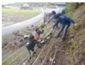
図11 レーダ探査実施状況
