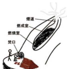
図13 瓦窯の模式図
