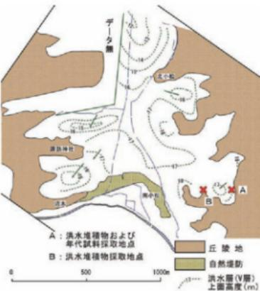
図3 北小松谷底平野の洪水堆積物上面高度分布
