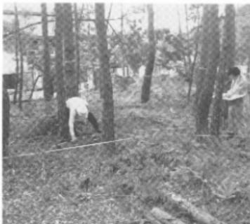
により、地中に渦電流（誘導電流）を生じる。この渦電流が作る二次磁界を地上で測定する。二次磁界は地中にある物質の導電率（物質の電気を通す能力の指標）によって異なり、二次磁界を測定することにより、地下の状況を判断する方法である。導電率（ $\sigma$ ）は抵抗率（ $\rho$ ）の逆数  $\sigma = 1/\rho$  で、単位は〔mho/meter〕で表される。金属は特に高い導電率を示すので、主に金属遺物の探査に用いられる。
