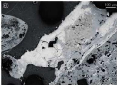
写真14 椀形鍛冶滓の顕微鏡組織 (2)
