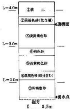
Fig. 4 土層柱状図 (1/40)
