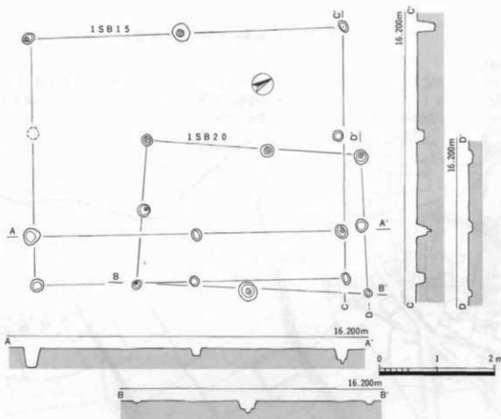
Fig.16 掘立柱建物実測図（1／60）
