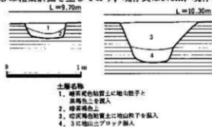
Fig. 15 1号溝土層断面図 (1/40)
