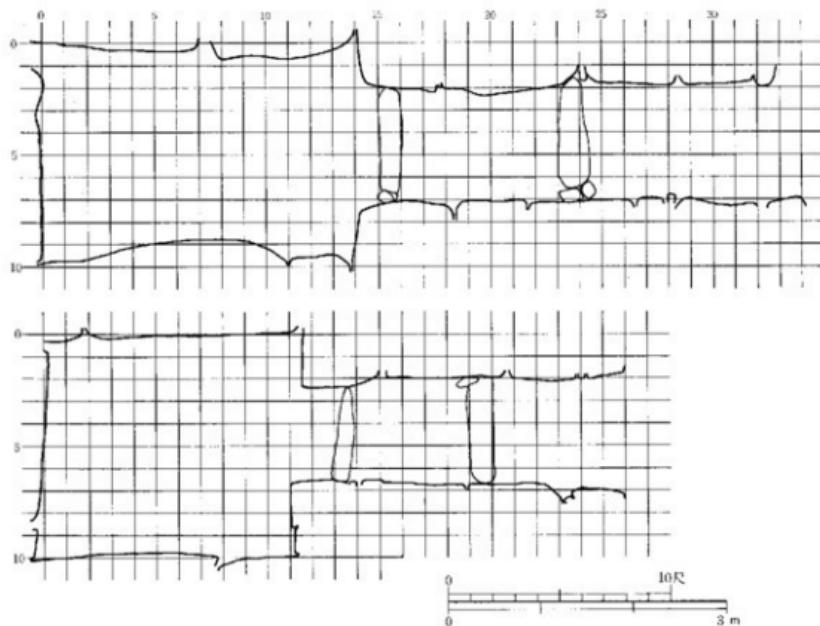
Fig31 (上) 高崎2号墳 (下) 今宿1号墳石室の方眼による操作結果 (縮尺1/60) 方眼1単位は24cm
