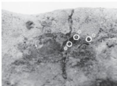
図81 坩堝（取瓶）の熔結付着物と分析部位
