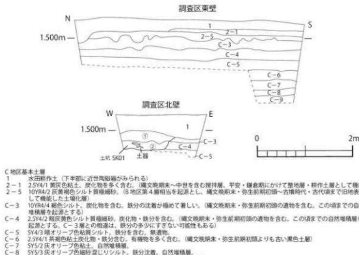
第13図 C地区東壁・北壁土層断面図（1/50）
